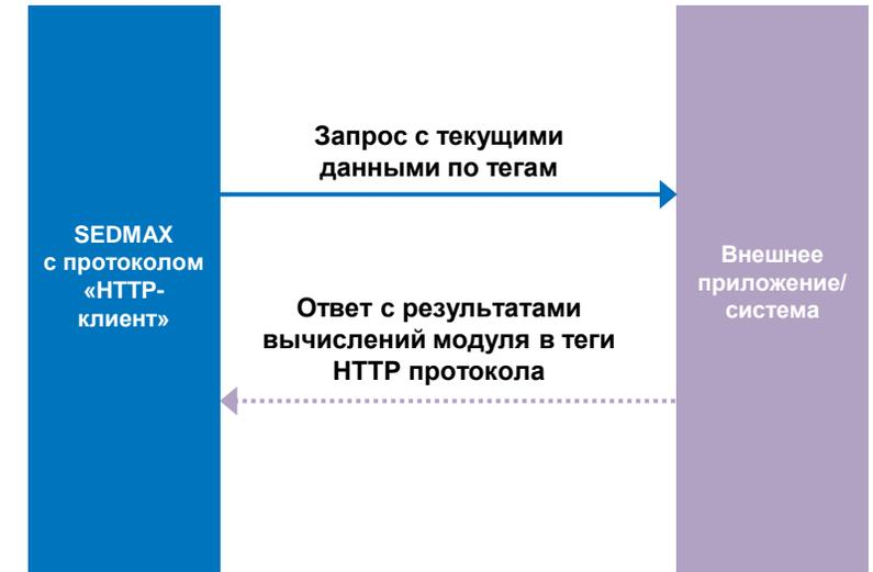
Схема взаимодействия определяется внешним модулем
